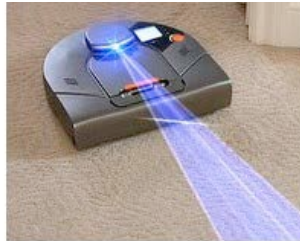
Exemple de capteur (laser) sur un robot aspirateur
