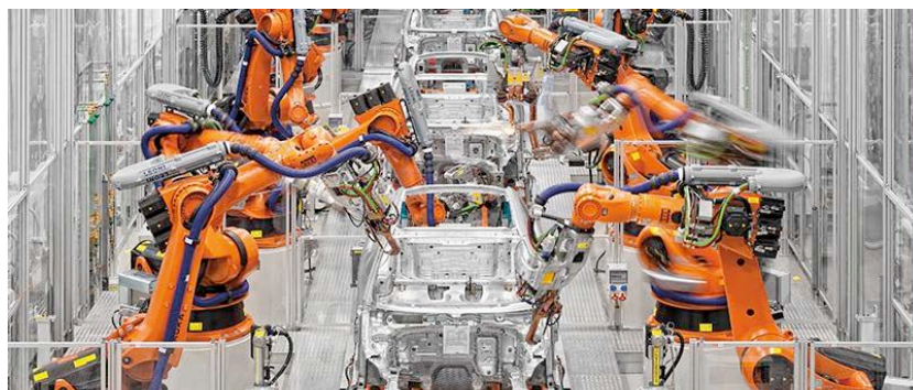
Robot pour la construction automobile (bras articulé)
